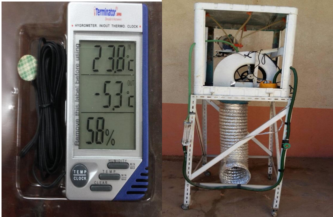
شكل رقم (3) المبردة المقترحة ذات تدفق ماء متغير. شكل رقم (4) جهاز قياس درجات الحرارة والرطوبة النسبية.
