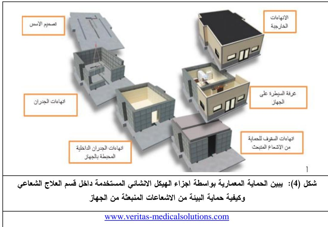
**1- الحماية بواسطة الارضيات:** يستخدم عادة في الارضية صب الخرسانة بسمك (150mm) حيث يوفر حماية بشكل واسع للارضية، وأن التدرج الإضافي يكون بشكل عام ضروري. حيث يمكن توفير ذلك عن طريق استخدام الخشب الرقائقي الرئيسي إلى الأعلى أو الأسفل، و يجب على التدرج الإضافي توفير حماية الثقوب التي يتم إجراؤها أثناء التنقيب [13].
