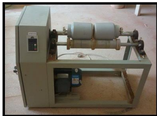
شكل (10) يبين جهاز الطاحونة المحورية
