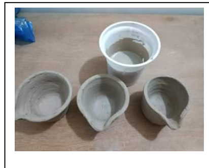
شكل (5) يبين البودقة ومحلول الألمومينا
