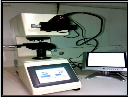
شكل (11) جهاز فحص الصلادة
